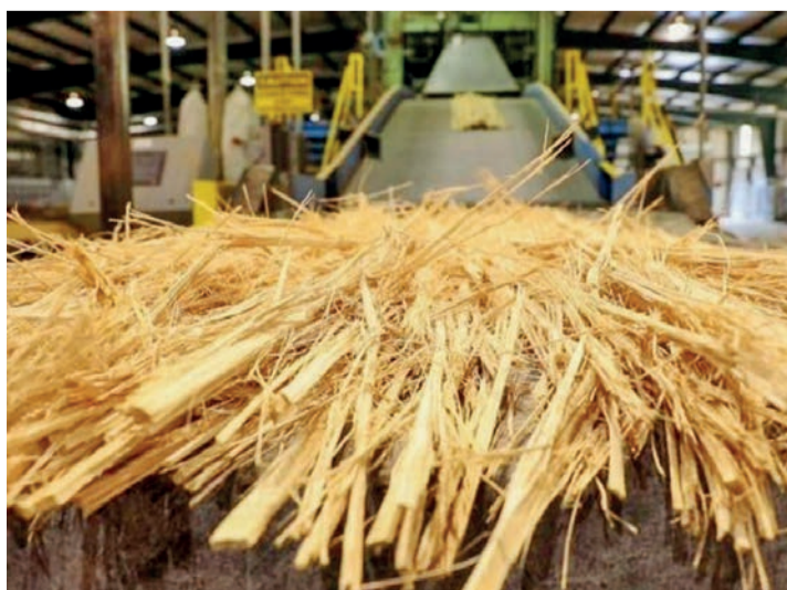
Wird das Rundholz in einzelne Fasern zerquetscht und dann wieder zusammengeklebt, können ungenutzte Holzabschnitte vermieden werden. Hier eine Anlage in einem Werk in den USA. Bild: zvg
