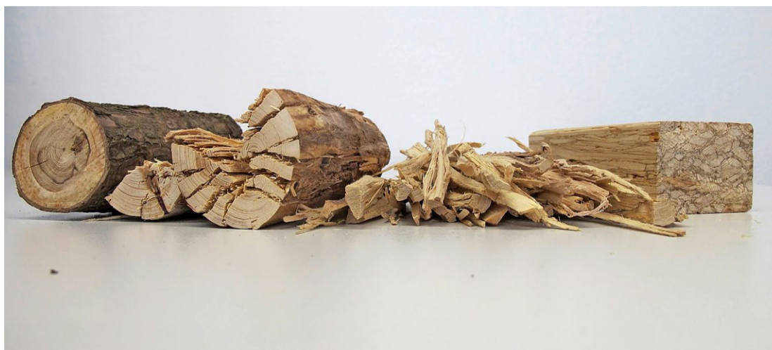
Beim Scrimber-Verfahren werden Baumstämme und Äste mit grossen Walzen in einzelne, spreisselartige Faserstränge zerkleinert. Die Spreissel werden danach mit Klebstoff angereichert und zu Bauprodukten in der gewünschten Form und Grösse verarbeitet. Foto: PD
